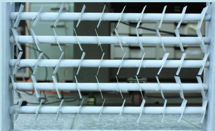
排管型吸收器加裝鰭片並塗佈二氧化鈦
