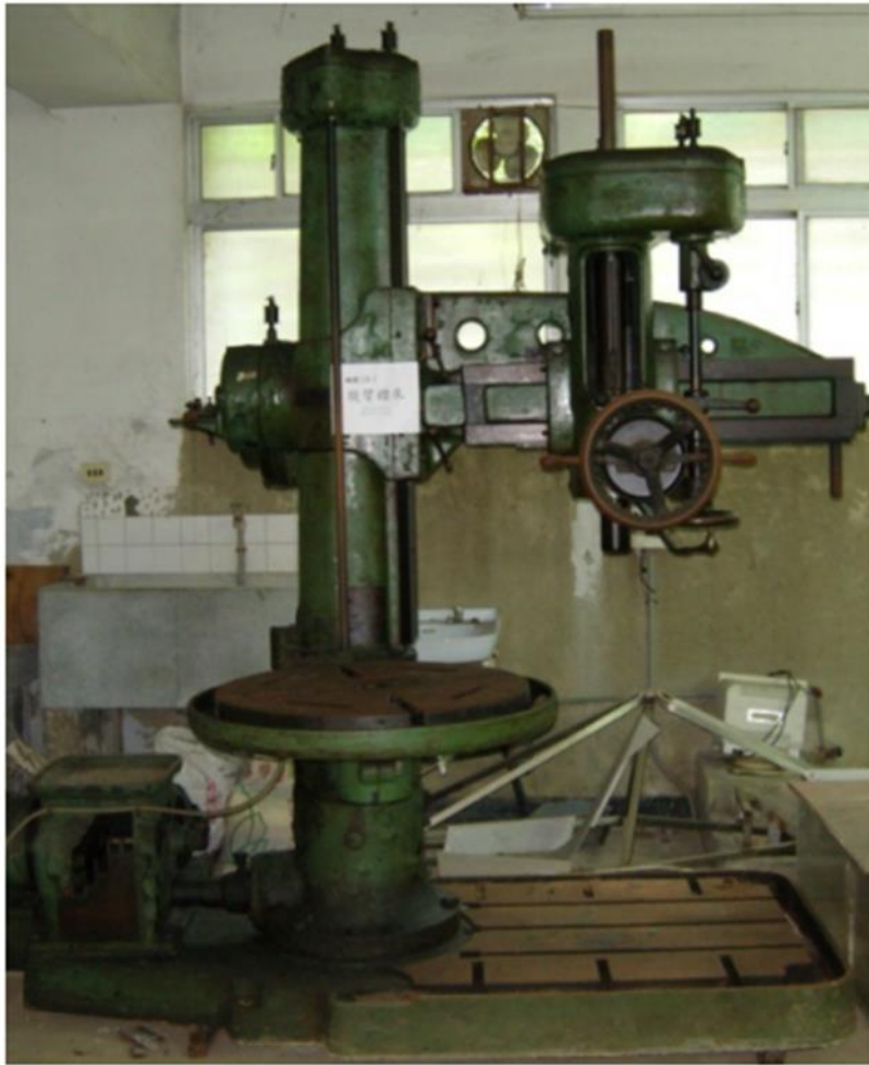
圖1 本系之日治時期旋臂鑽床 (保存於機械系館地下二樓)
